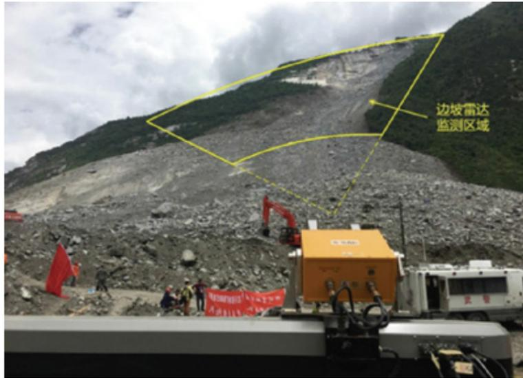
滑坡灾害预警设备基于地基合成孔径雷达差分干涉技术,具有全天候、大范围、非接触、高精度、无人值守和实时预警等6大特点,能够对露天采场、排土场边坡、渣土场、尾矿库坝坡、水电库岸和坝体边坡、山体滑坡、建筑物及地表沉降等进行安全监测预警。
