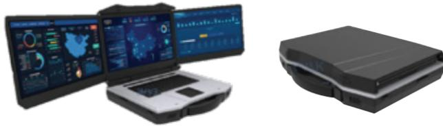
便携式应急指挥台是专为现场应急指挥调度打造的一款工作台，外观采用手提式设计。外观采用手提式设计，四周采用加固包角，方便携带进入多种恶劣的应急现场。三个 15.6 英寸全高清屏，可以将指挥调度、地图显示和视频监控一机显示，将全部信息立体化呈现，大大提高决策的及时性和准确性。
