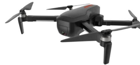
高清图传无人机搭载自组网模块，能够在应急无网络场景中对未知地貌快速巡查，实时和前方指挥中心进行通信，并将高清视频传回地面，为前方指挥人员快速决策提供有效的支撑。
