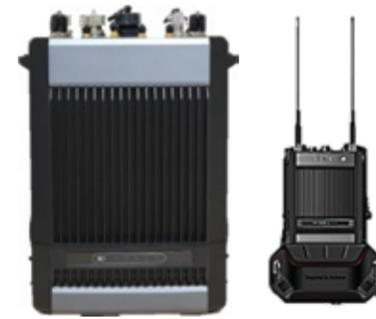
背负式图传单兵是基于 4G 和 5G 移动通信技术，面向承载专网综合业务而设计，具有部署便捷、组网灵活、吞吐率高、可靠性强等特点，具备端到端的业务质量 (QoS) 保障机制和安全保护机制。设备上电即可自组成网，也可以和蜂窝无线网络、有线网络配合使用，支持多种网络拓扑，应用灵活，适用各种复杂环境下的无线组网，支持音视频采集、高效编码、低时延传输要求。该设备主要用于单兵背负，体积小、重量轻、功耗低，支持通用电源供电，待机时间长达 4 小时以上；支持多种数据接入方式，包括有线以太网、WiFi 以及蓝牙设备等，可连接 HDMI 接口摄像机及模拟摄像机使用。
